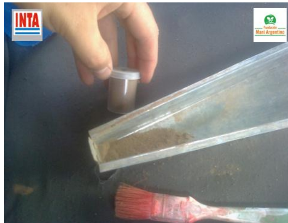
Fig .3 Recolección del material erosionado.
