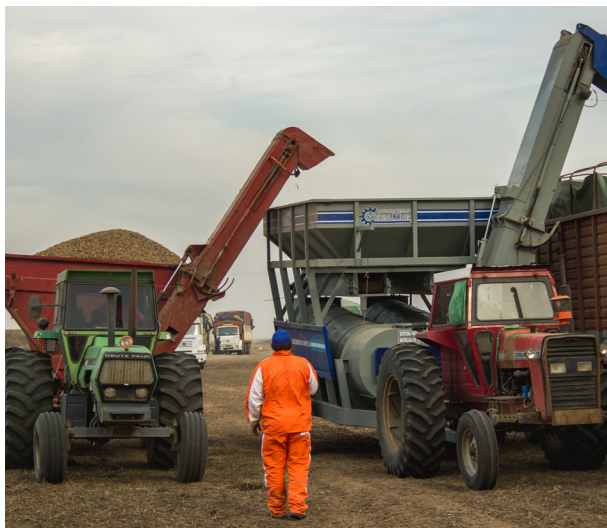
Prelimpieza en el campo
