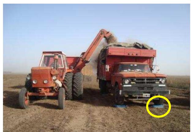
Foto 5. Descarga y Pesaje. Circulo: balanza
